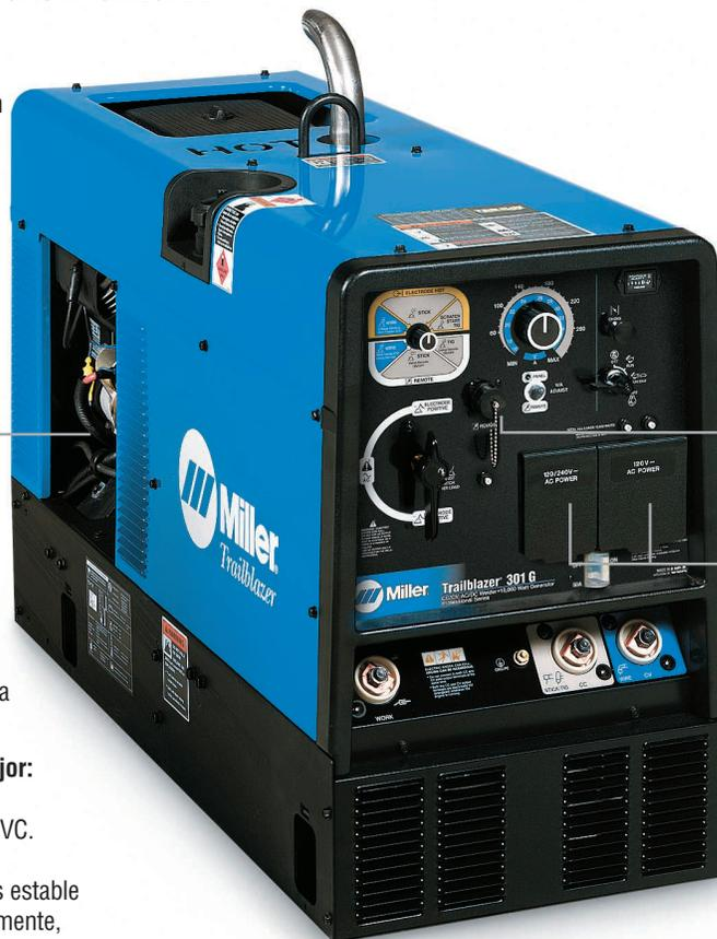
**Arranque automático en ralentí™ (motor diésel)** hace marchar al motor en vacío de inmediato al arrancar, para extender la durabilidad del motor y reducir el consumo de combustible y ruido
